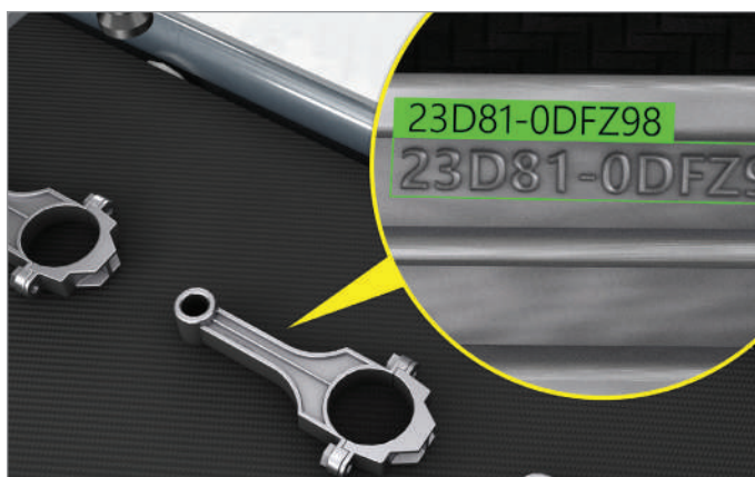
汽車文字閱讀: 讀取批號和各種文字類型,包括扭曲、斜角或直接標示的零件標記字元,以準確追蹤零件
